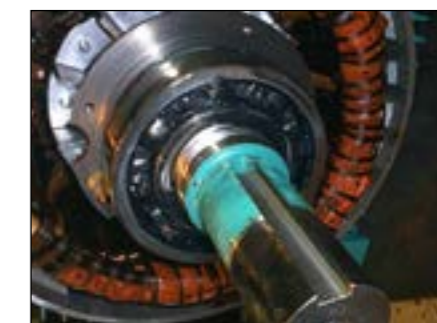
Motorens akselspenning kan forårsake elektriske utladninger i kulelageret som kan resultere i lagernedbrudd.
